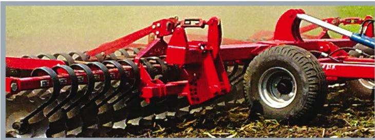
Две навесные системы носителя позволяют навешивать орудия категорий II, III, с возможностью регулировки рабочей высоты навешивания орудий.
