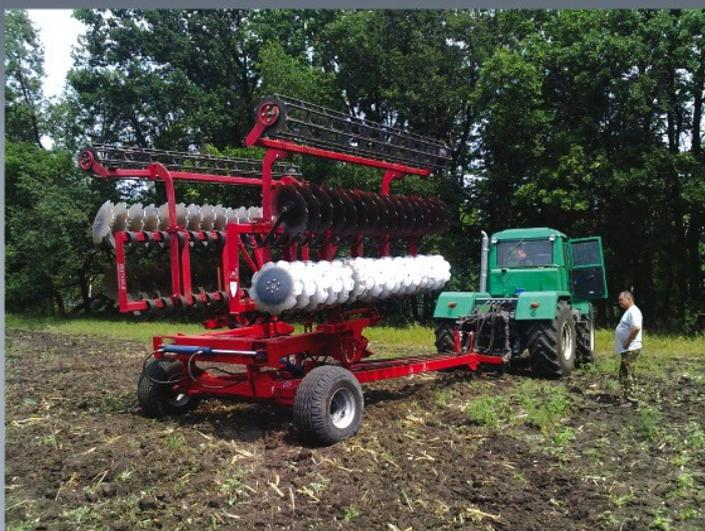
Быстрый перевод орудия из рабочего положения в транспортное и наоборот способствует увеличению производительности работы, а надежный, гидравлически управляемый замок позволяет быстро фиксировать орудие в транспортном положении.
