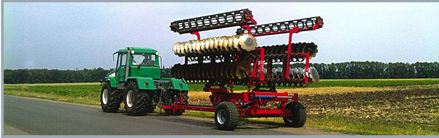
Конструкция системного носителя позволяет эффективно копировать рельеф поля, тем самым обеспечивая отличное качество обработки.
