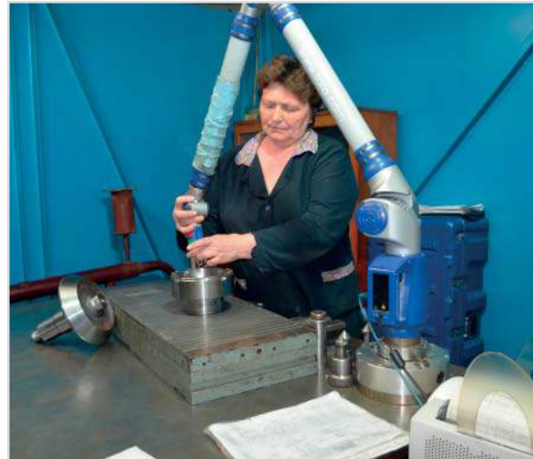
Контрольно-измерительный манипулятор FARO в работе
